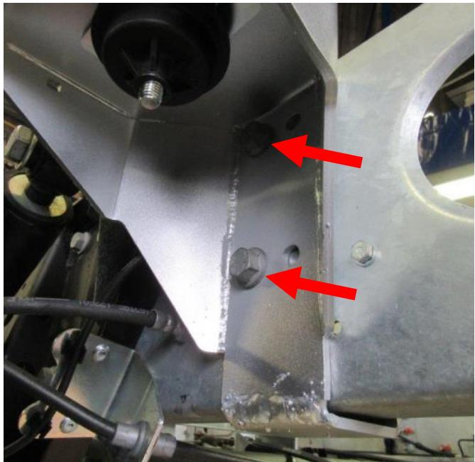
**NL** Plaats de beugel met de voorste gaten op de gaten in het chassis. Plaats de originele bouten M12x30 (SW18) en zet de moeren vast.
