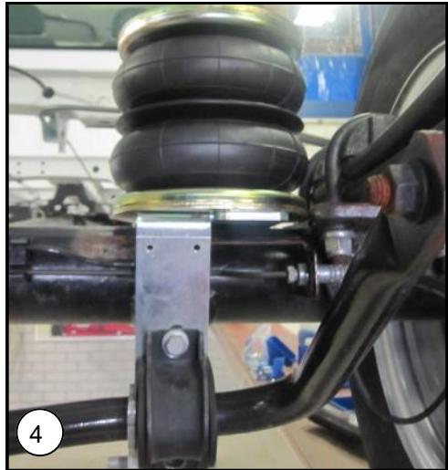
**NL** Monteer de balg op de onderplaat, en plaats de rechter onderplaat zoals hiernaast te zien is op de as. Zorg ervoor dat de balg uitgelijnd is met de bovenplaat.
