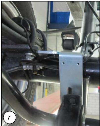
**NL** Monteer de balg op de linker onderplaat, en plaats de plaat zoals hiernaast te zien is op de as. Zorg ervoor dat de balg uitgelijnd is met de bovenplaat.
