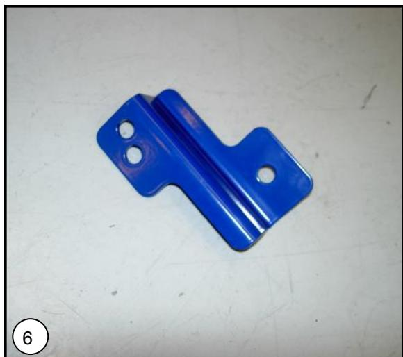
**NL** Gebruik de plaat die hiernaast is afgebeeld om de steun voor de remleidingen te verleggen. Verbuig de remleidingen voorzichtig met de hand!
