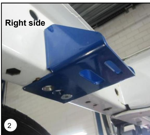
**NL** Plaats de beide bovenplaten op de plek van het aanslagrubber wat verwijderd is.
