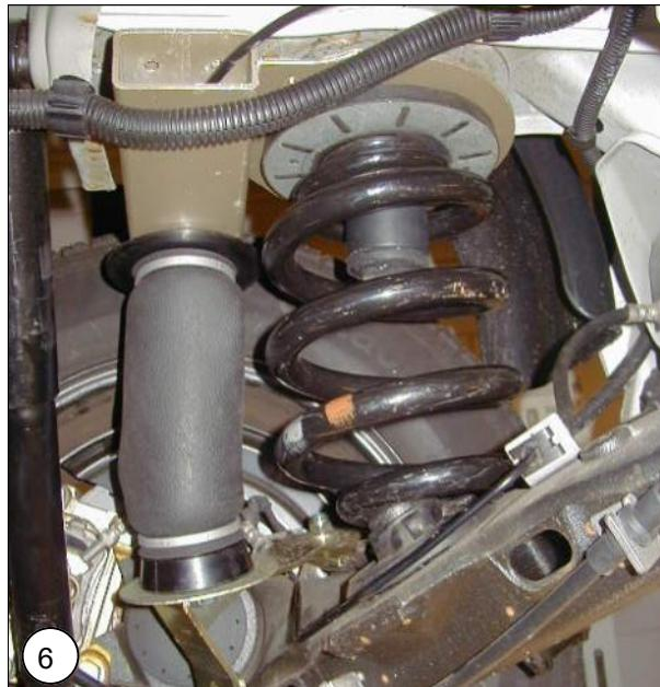
**NL** Plaats de hoofdveer en zet de auto weer op zijn wielen. Let op dat de bovenbeugel goed in het chassis centreert en dat de veer goed in de slotjes van de originele veerschotels valt. Montere de onderste schokdemper bevestiging (**150 Nm+90°**)
