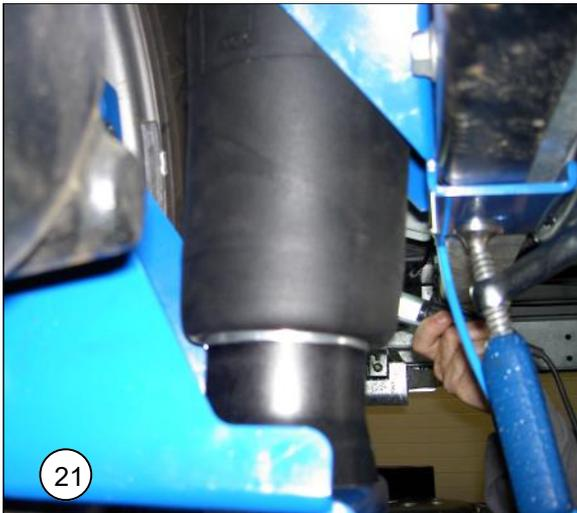
**NL** Zet de balgen op druk en controleer of de balg goed gepositioneerd is, ook met de veerbeweging van de as.
