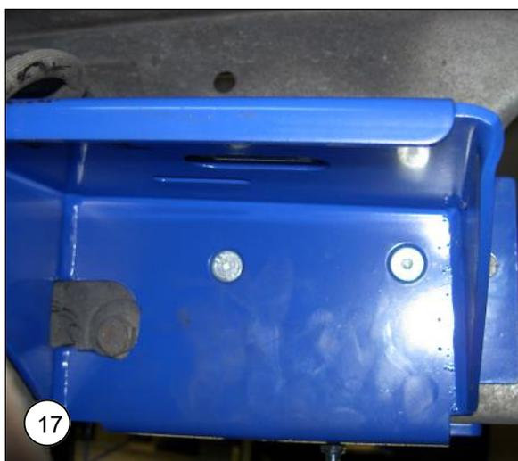
**NL** Boor nu twee gaten van 10 mm en een van 8 mm in het chassis, om de bovenplaat vast te zetten.
